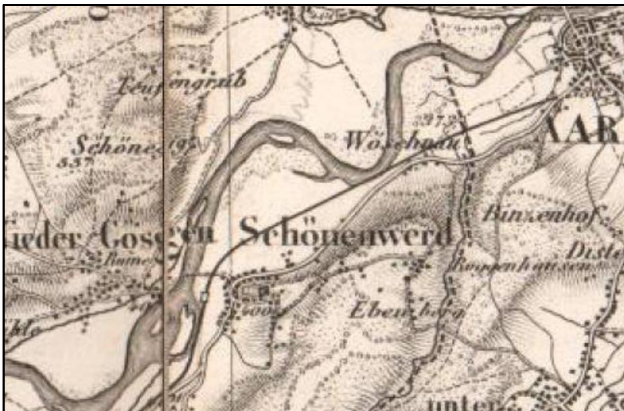
Ausschnitt aus der Dufour-Karte von 1861. Die Aare fliesst bei Schönenwerd von Süden nach Norden, was manchmal verwirrt. Auf der Höhe von Erlinsbach ist die Verschiebung des Flussbettes in den nördlich gelegenen Hang sichtbar, die durch das Hochwasser von 1852 verursacht wurde.
